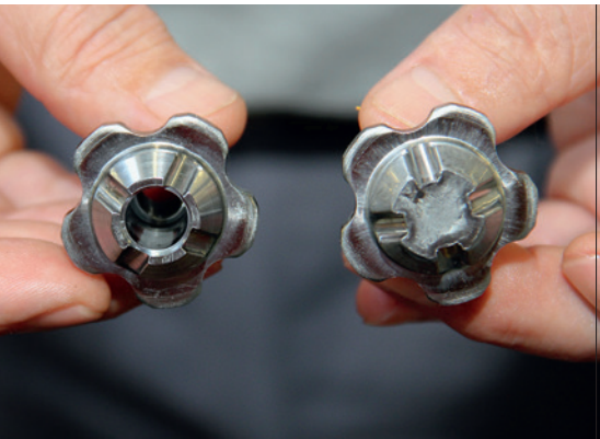
Auf der Mikron VX-10 werden rohe Umformteile (rechts) zu fertigen Bauteilen veredelt (links).
