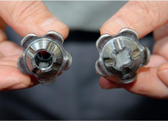
Sur la Mikron VX-10, les pièces brutes formées (à droite) sont converties en pièces finies (à gauche).
