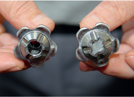
Con le Mikron VX-10 i pezzi stampati grezzi (destra) vengono trasformati in componenti finiti (sinistra).
