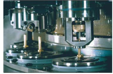
Usinage avec douille de guidage
