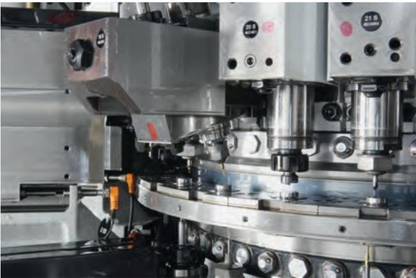
Bearbeitungseinheiten operieren von allen Richtungen
