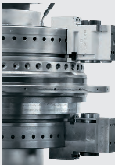
Supporto stazioni di lavoro regolabili (in alto e in basso) con tavola rotante incorporata.
