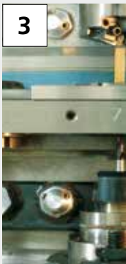
上工位预车， 下工位钻孔
