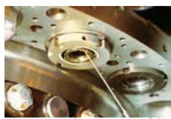
斜孔深孔钻, 下工位
