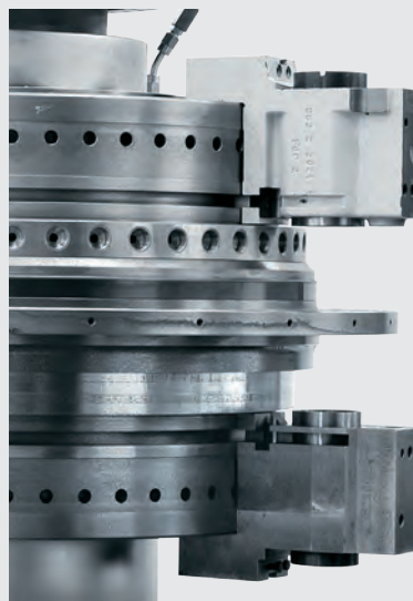
Supports de station de travail réglables (en haut et en bas) avec plateau à indexage intégré.
