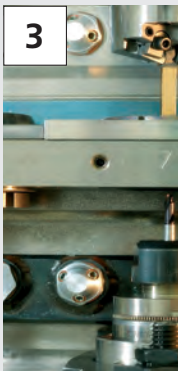
Tournage ébauche au dessus, perçage en dessous
