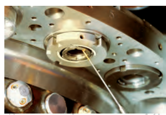
Perçage profond en biais par le dessous
