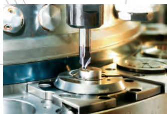
Fresatura del piano con smussatura
