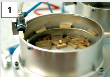
1 Alimentazione con trasportatore a vibrazione
