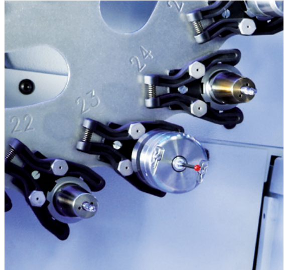
Der Messtaster wird wie jedes Werkzeug in nur 1 Sekunde eingewechselt.
