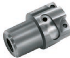
Pièce avec des opérations de fraisage à 4 axes
