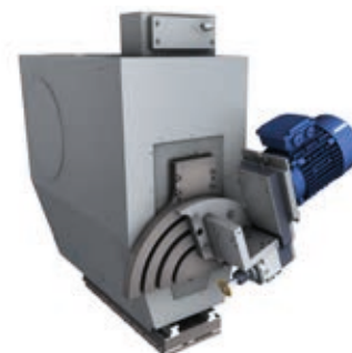
Unità di lavorazione a 3 assi CNC con mandrino inclinabile liberamente
