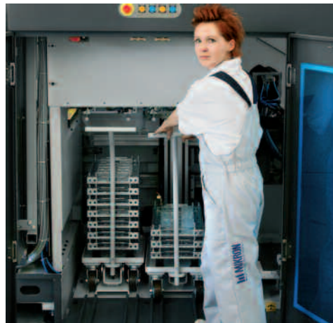
Un véritable jeu d'enfant ! Alimentation du module de chargement via magasins à empilage, par exemple. Ces chariots pour palettes garantissent une autonomie de production élevée au fil des équipes de travail.
